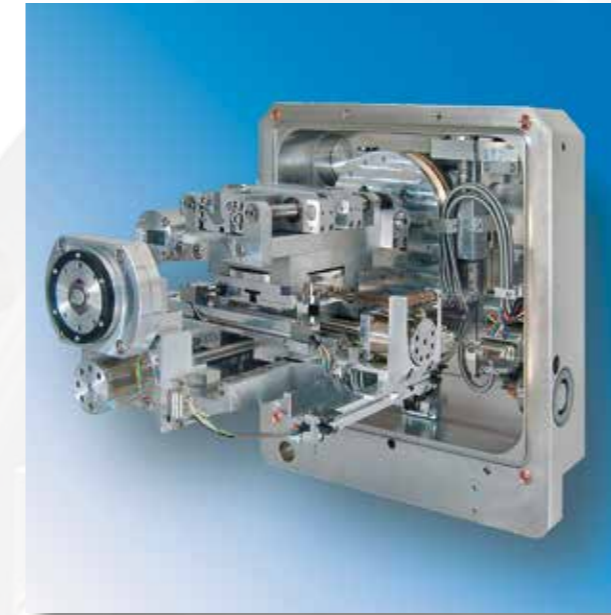
Modul für Heiz- und Zugversuche montiert auf einem Manipulator für Rasterelektronenmikroskope
